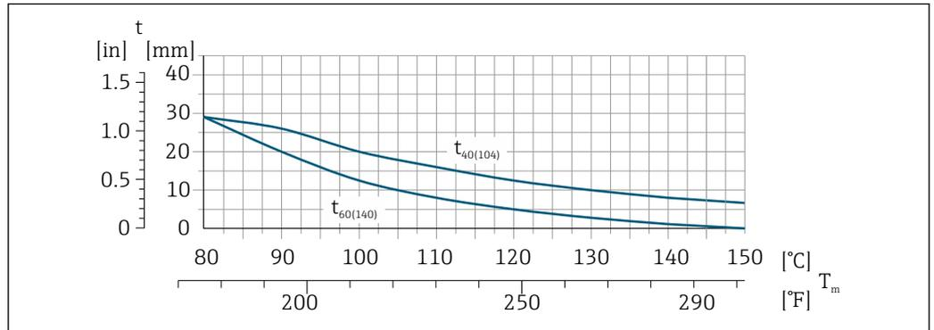
38 Рекомендованная максимальная толщина изоляции зависит от температуры продукта и температуры окружающей среды
