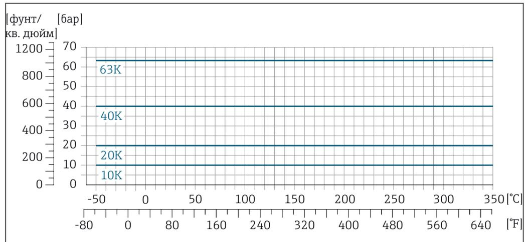
28 С материалом фланца 1.4404 (F316/F316L), сплав Alloy C22
