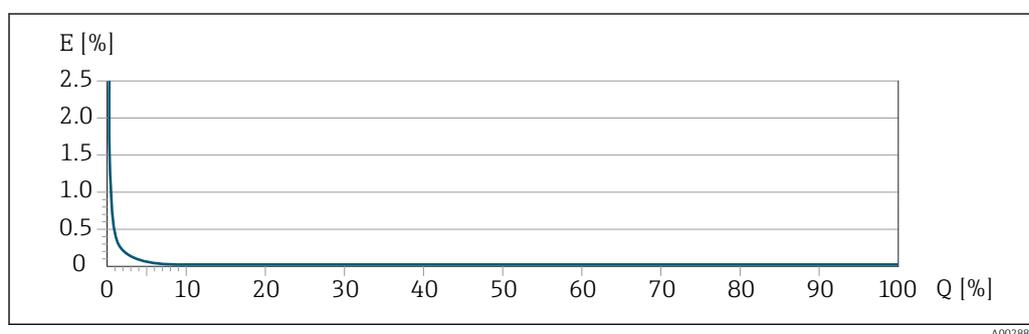
E Погрешность: максимальная погрешность измерения, % ИЗМ (пример с применением PremiumCal)
